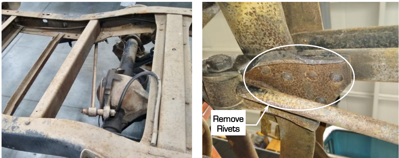
Figure 3 - Remove Panhard Bar & Bracket
